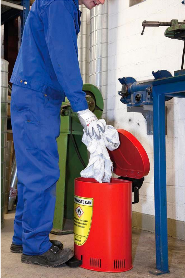
Abb. 30 Sammlung von gebrauchtem Putzmaterial
