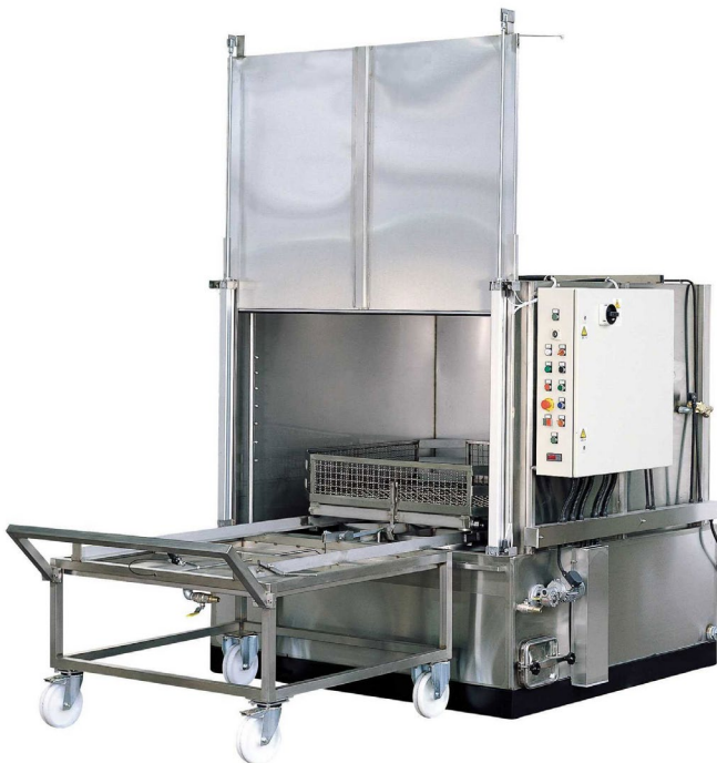
Abb. 13 Waschautomat für wässrige Lösungen
