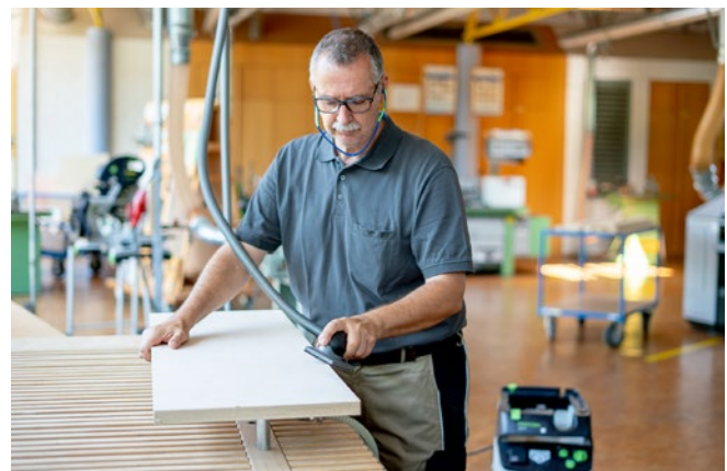
Abb. 12.6 Tischler bearbeitet Werkstück mit einem abgesaugten Handschleifklotz
