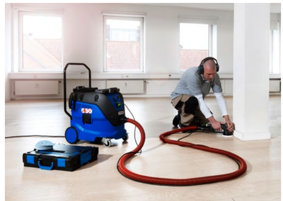
Abb. 10 Absaugung eines handgeführten Elektrowerkzeugs
